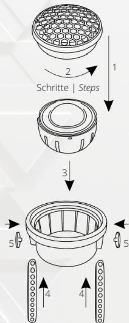
Mit dem Universal-Ring sind verschiedenste Montagemöglichkeiten zu realisieren. In der gezeigten Konfiguration mit dem Metallband der Hochtöner zum Beispiel auf einer A-Säule des Fahrzeuges ausgerichtet und anschließend mit optionalen Glasfaserspachtel modelliert werden.
