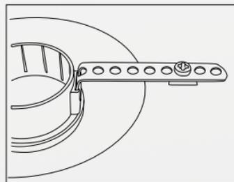
Bei der Verwendung in originalen Einbauplätzen wie zum Beispiel im Amorturenbrett kann der Ring gedreht verwendet werden.
